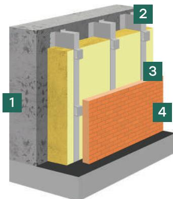
1. Железобетонная монолитная стена толщиной 200 мм или пилоны толщиной 250 мм
