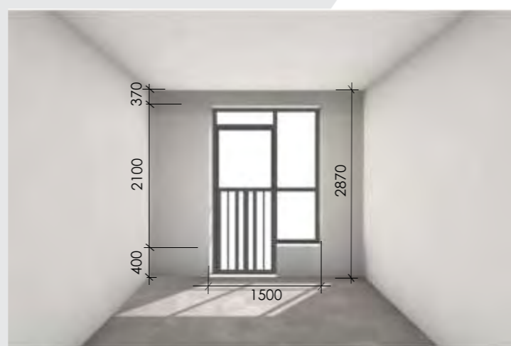
Окно 1500x2100 мм. с выходом на французский балкон с ограждением из черного металла
