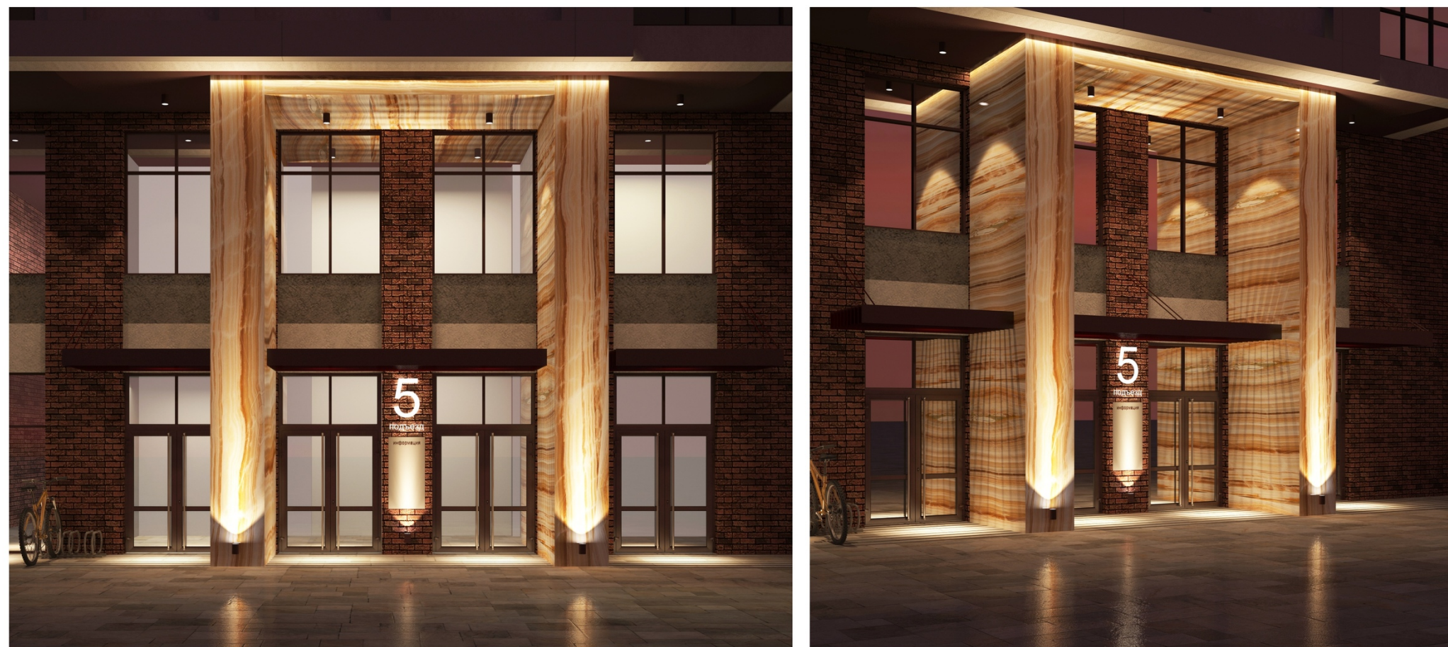
Освещение - направленные архитектурные светильники, плюс закарнизная подсветка.
